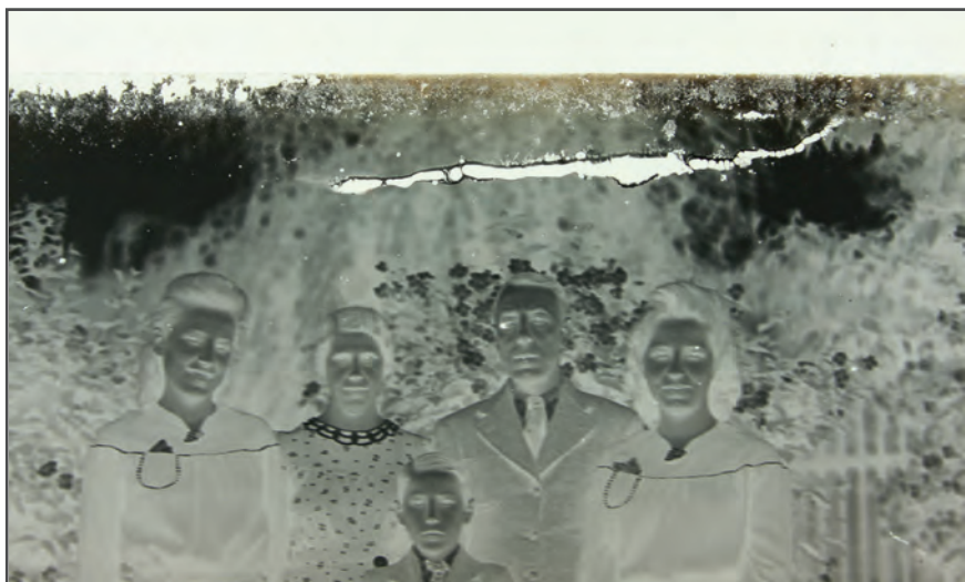
Obrázek 47: Mechanické poškození citlivé vrstvy
