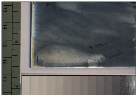
Obrázek 58: Detail matného povrchu citlivé vrstvy s nečistotami 150
