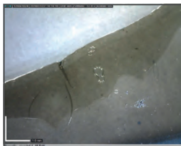
Obrázek 57: Makroskopický snímek diapozitivu s lesklým povrchem i s drobnými bublinkami 149
