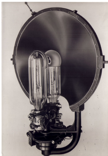
Obr. 44: Systém automatické výměny světelného zdroje firma Kolář, Modřany
